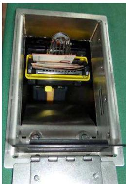
Links das DAC100 mit abgenommener Deckplatte und entfernter Innenplatte. Die Deckplatte verdeckt die Schlösser, die den Zugang zur Stackerbox kontrollieren, und verhindert das Herausnehmen des Akzeptorlesekopfes. Die Deckplatte kann selbst mit zwei Schlössern gesichert werden. Auf dem Bild ist zu sehen, dass die Schlösser der Schiebetür der Sicherheitsbox geöffnet sind und die Tür teilweise nach oben herausgezogen wurde.
